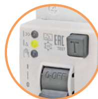
KZS EDI - "OFF" Вимкнений від спрацьовування блоку диференційного захисту (Горить жовтий LED)
