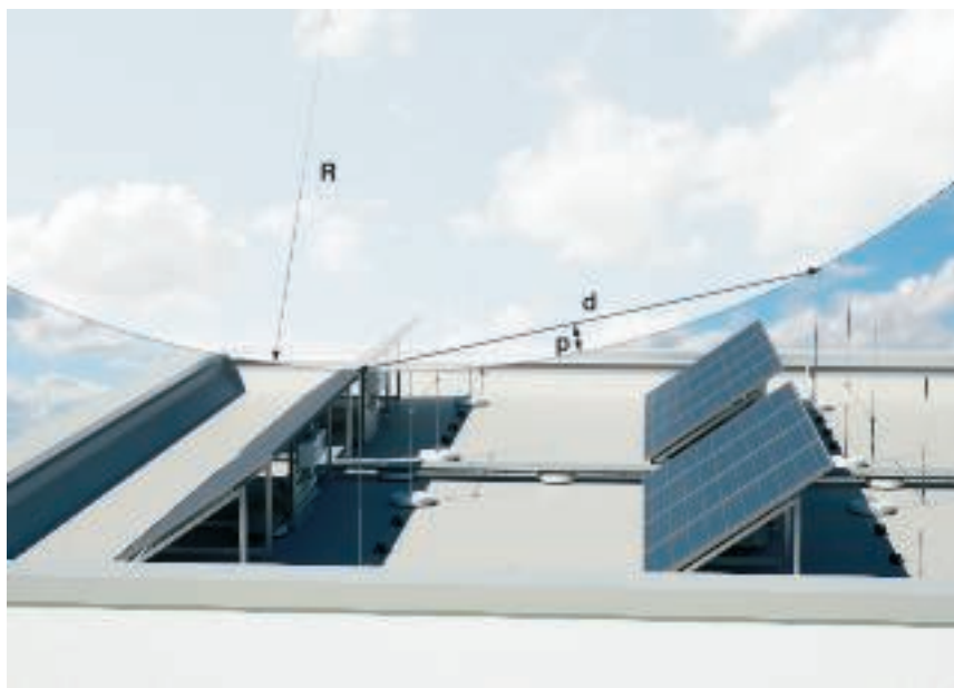
p = глубина проникновения, R = радиус сферы вращения, d = расстояние до молниеприемного стержня
