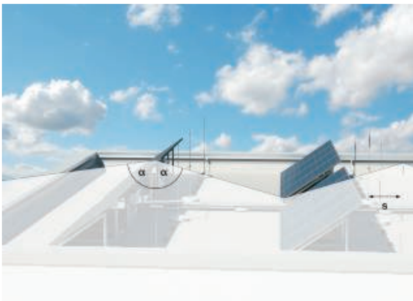
\alpha^\circ = защитный угол, s = разделительный интервал
